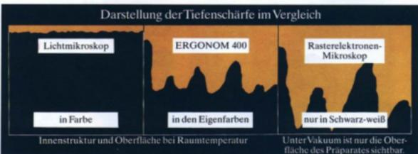
Bild 5: Schematische Darstellung der Tiefenschärfe des Mikroskops Ergonom 400
