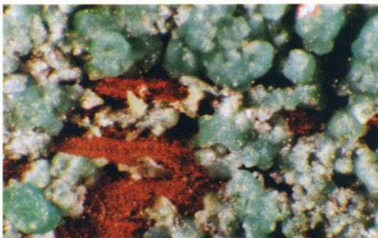
Bild 2 Die dunklen Stellen sind die nicht abgedeckten Bereiche der Rohrinnenfläche. (Innenfläche wie Bild 1, linke Seite, unbehandelt, Vergrößerung 342fach)
